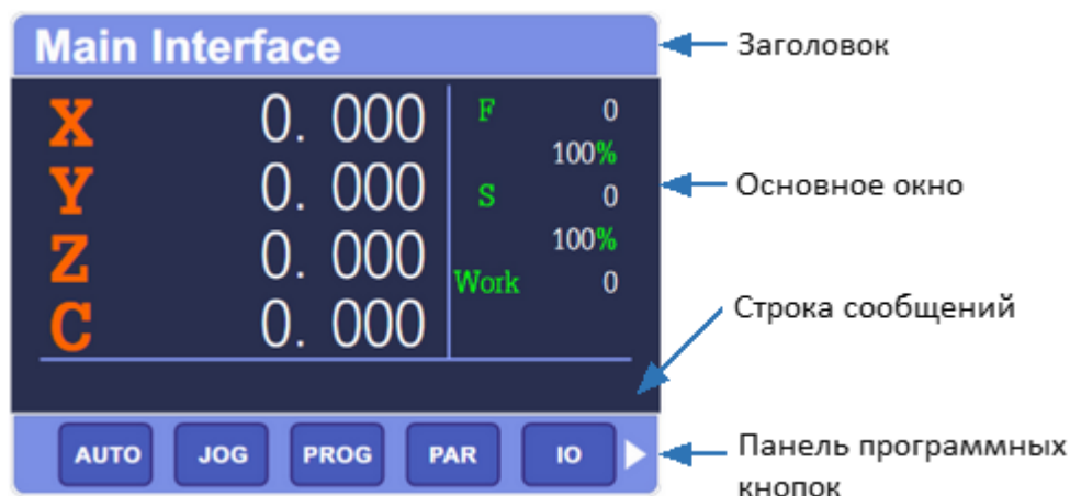
Основные элементы экрана контроллера
